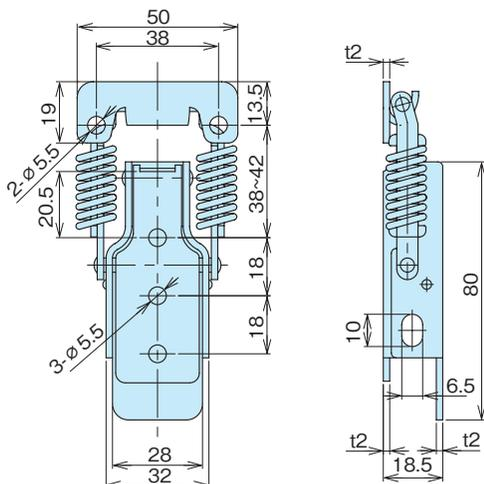
**特徴** ● スプリングにより、締付力をアップさせています。
