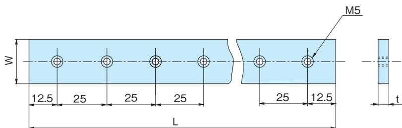
**特徴** ●制御盤、分電盤の母線及び、分岐用母線バーに最適です。
