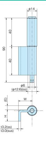
徴 ●ピンが抜差しでき、取付けが簡単です。
