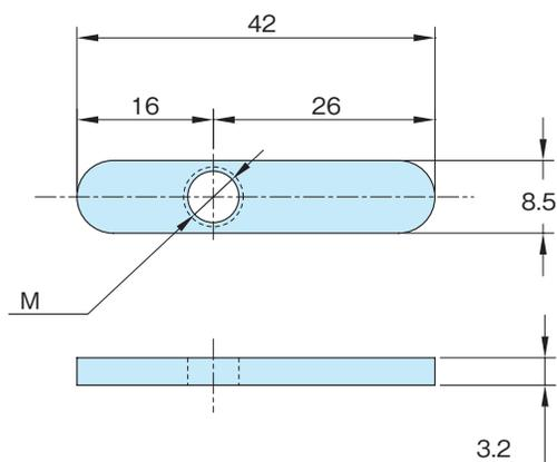
**特徴** ●ボルトにピースナットをセットさせておきチャンネルの穴に表からナットを差込むと、裏から手を添えなくても部品や機器の取付ができます。
